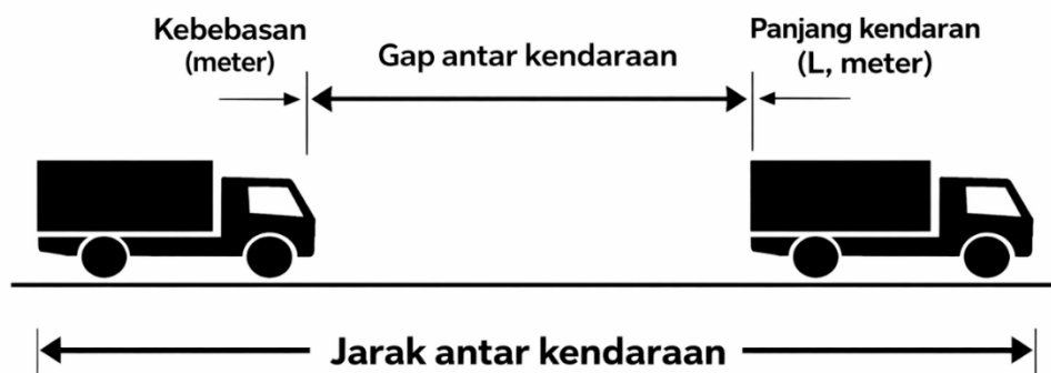
Figure 2. Konsep clearace, gap dan spacing dan headway
