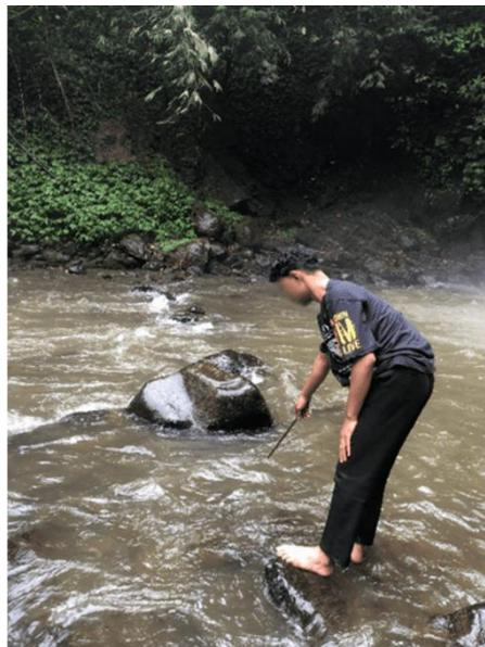
Gambar 2. Pengukuran kecepatan aliran air menggunakan benda terapung
