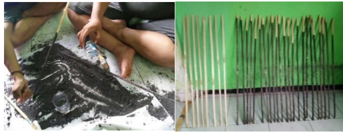
Gambar 2. Treatment bambu sebagai tulangan Sumber: dokumentasi MF Faisal (2016)
