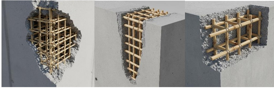
Gambar 4. Visualisasi panel beton ringan bertulang bambu Sumber: dokumentasi peneliti
